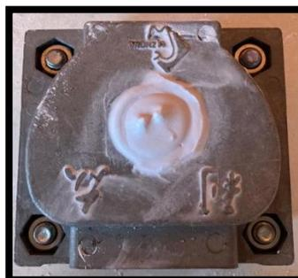
Gambar 3.12 *Flasking* *cuvet* atas
