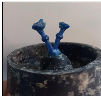
Gambar 3.7 Pemasangan Sprue ( Spruing )
