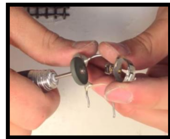
Gambar 2.27 Memoles dengan cotton wheel (Sumber : Kumar Ravi,2014)
