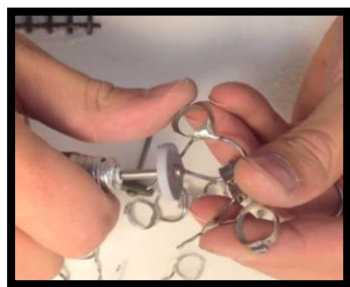
Gambar 2.26 Meratakan dengan rubber wheel (Sumber : Kumar Ravi,2014)
