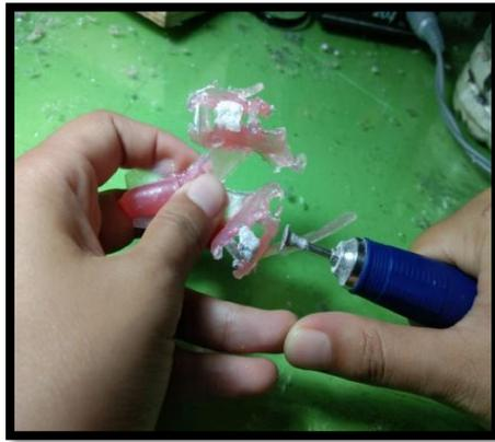
**Gambar 3.17 Pemotongan *Sprue***
