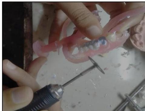
**Gambar 3.12 pemotongan *sprue***
