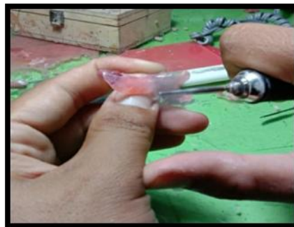
Gambar 3.24 Tahap Finishing Menggunakan Mata Bur Mandril Amplas
