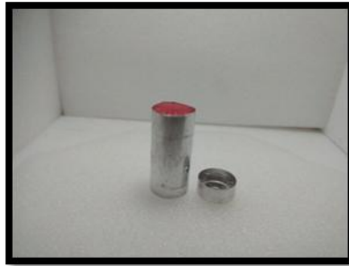
Gambar 3.18 Catridge Berisi Butiran Bahan Nilon Termoplastik
