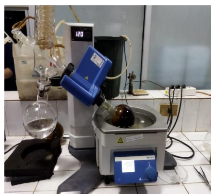
Gambar 13 Penguapan maserat dengan evaporator sehingga didapatkan ekstrak
