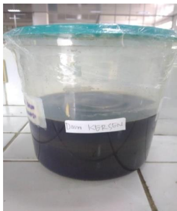
Gambar 10 Perendaman bubuk daun kersen dengan pelarut etanol 96% (maserat 1)
