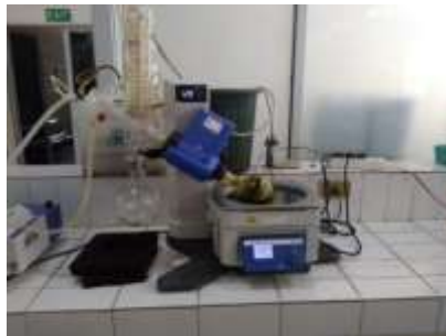
Proses Evaporasi Dengan Rotary Evaporator
