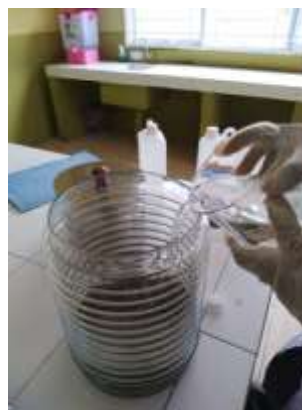
Tuangkan Seluruh Pelarut Kedalam Toples Berisi Simplisia Daun Jambu Biji
