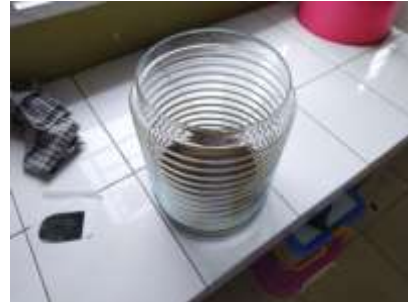
Tuang Serbuk Simplisia Daun Jambu Biji Ke Dalam Wadah Maserasi (Toples)
