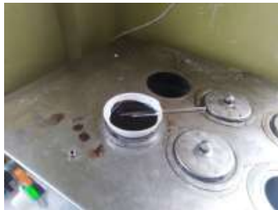
Proses Pemekatan Ekstrak Menggunakan Waterbath
