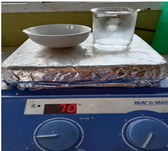
Peleburan fase minyak dan pemanasan fase air diatas hotplate pada suhu 70°C
