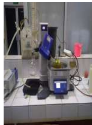
Proses evaporasi menggunakan rotary evaporator
