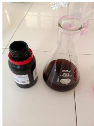
Ditambahkan indikator pp 1%, larutan sabun berubah menjadi kemerahan
