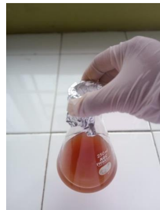
TAT uji alkali bebas (merah tepat hilang kembali menjadi warna asli sabun)
