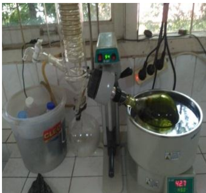
Proses penguapan maserat di rotary evaporator
