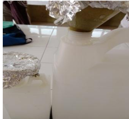
Proses penyaringan remaserasi (maserat 1 + maserat 2)
