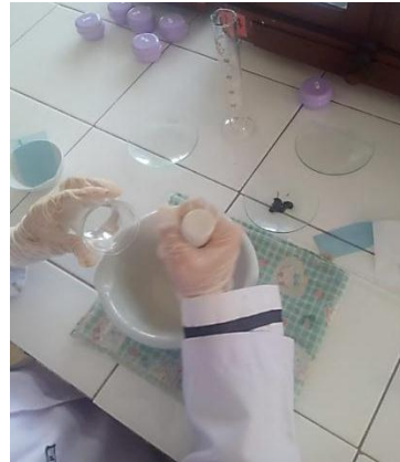
Dimasukkan fase air sedikit demi sedikit ke mortir, gerus ad homogen
