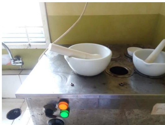
Dipanaskan mortir dan stemper di atas waterbath hingga dinding mortir hangat
