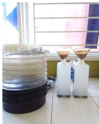
Setelah direndam 24 jam dan diaduk setiap 3 jam sekali, dilakukan penyaringan (Maserat 2)
