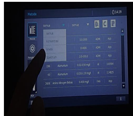
Dihidupkan spektrofotometer UV-Vis dan pilih menu spektrum
