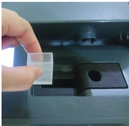
Dibilas kuvet untuk pelarut dengan aquadest dan etanol 96%
