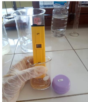
Diukur dengan pH meter dan dilihat hasilnya
