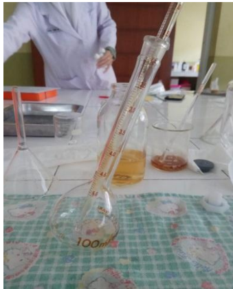
Dipipet 5 ml filtrat, masukkan ke labu ukur, dan tambahkan etanol ad 100 ml
