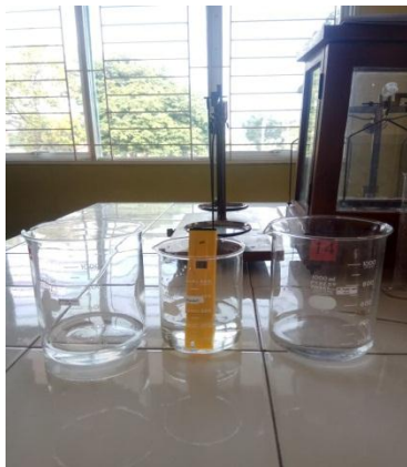
Dikalibrasi pH meter dengan pH buffer 4,01 dan 6,86.
