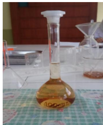
Dimasukkan labu ukur lalu tambahkan etanol 96% ad 100 ml
