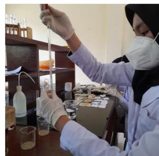
Memasukan air sampel ke dalam tabung reaksi
